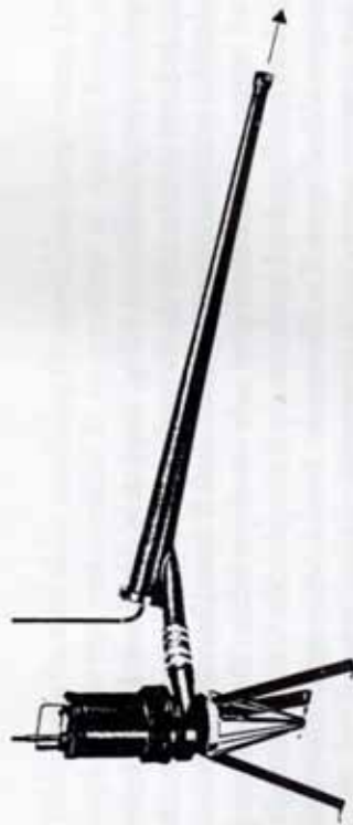
I PKS HYDROVITAL blandas luft och flytgödsel i en kraftig virvel. Därigenom blir det en intim kontakt mellan gödselpartiklar och syre och en intensiv biologisk nedbrytning sker. Dålig lukt och hälsorådliga gaser försvinner. Gödselns biologiska värde för marken ökar. (Implosion nr 70)
